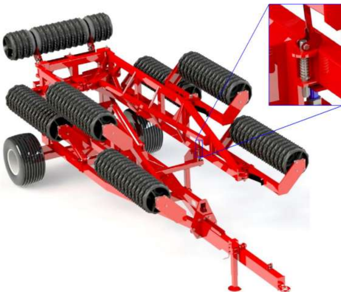
Рис. 11 Расположение фиксаторов на раме катка
